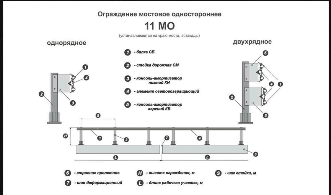
В зависимости от уровня удерживающей способности ограждения изготавливают одноярусной и двухъярусной конструкции (с одним или двумя ярусами балок по высоте).
